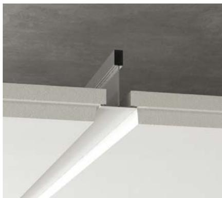
**SL, SLT et SLN (Téglulaires)** - Les panneaux à bordures téglulaires sont suspendus à un système de suspension visible et encastrée, qui crée une ombre entre les panneaux. Les panneaux téglulaires sont carrés (SL, SLN) ou à angle (SLT) et peuvent être montés dans un système de suspension avec des profilés de 9/16" (SLN) ou 15/16" (SL, SLT). Le profilé plus étroit de 9/16" est moins apparent. Les panneaux de plafonds à bordure téglulaire sont démontables.
