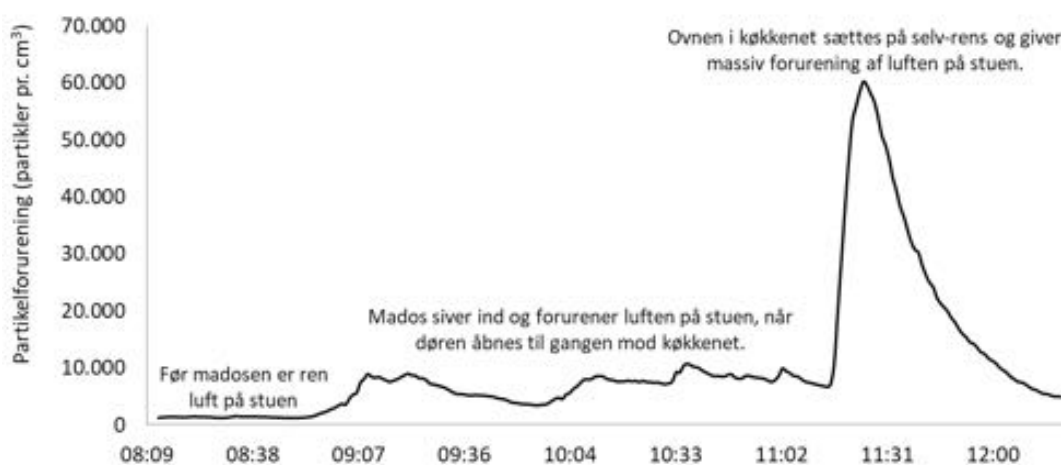
Figur 5. Af figuren ses det, at når madlavningen påbegyndes i køkkenet kan der ses en stigende forurening af ultrafine partikler på børnehavestuen. Dette skyldes, at madosen hurtigt siver fra køkkenet og ud i institutionens andre rum. Det er dog i dette tilfælde ikke i høje niveauer. Der opstår til gengæld en massiv forurening af stuen, når ovnen i køkkenet sættes på selv-rens funktion. Måleapparatet er opstillet i en af institutionens stuer.
