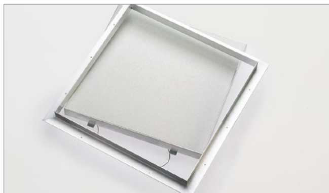
Openen van het luik. Til het volledige luik 50 mm op en schuift het (boven het ophangstelsysteem) enkele centimeters opzij, waarna de tegenoverliggende zijde van het luik naar beneden wordt gedraaid.
