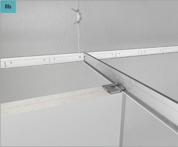
Fissati i Rockfon Universal Baffles ai profili T24, usare le asole dei profili T24 per allineare i Rockfon Universal Baffles.
